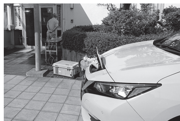
台風被害を受けた千葉の公民館に電力を供給するリーフ。
